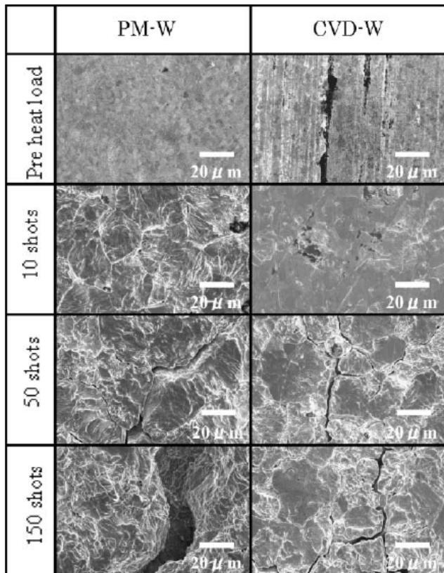
Max. Temp.  $\sim 1300^{\circ}\text{C}$  (50MW/m<sup>2</sup>)
